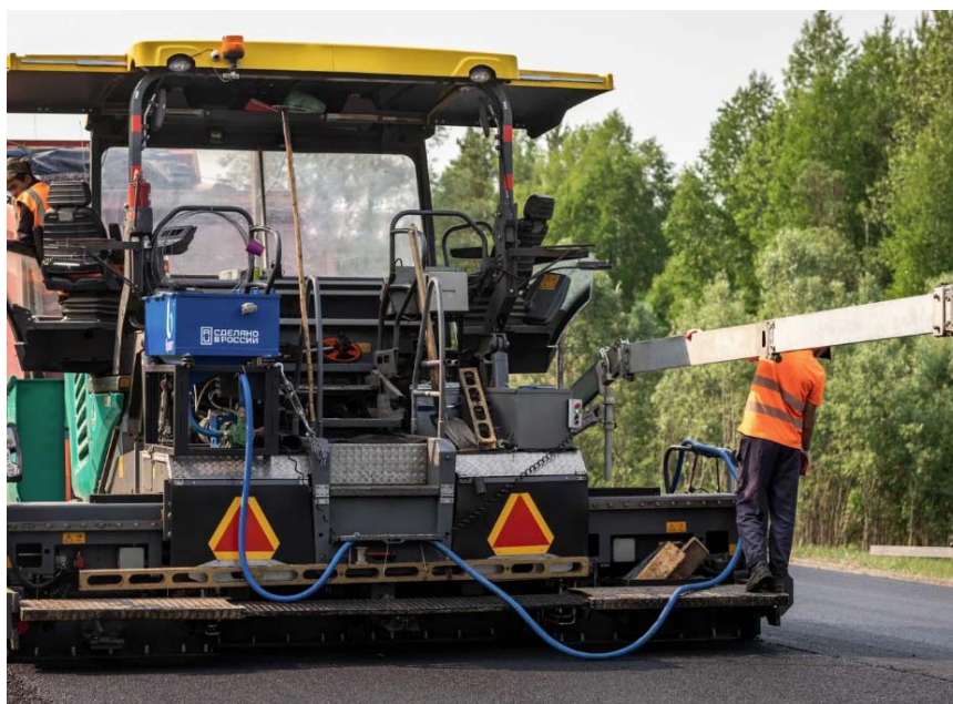
Рис. 2. Модуль для применения жидкой битумно-полимерной ленты на асфальтоукладчике
