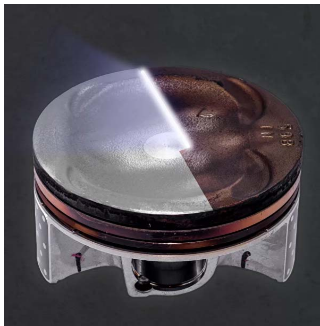
Рис. 1. Процесс использования лазерной установки на поршне автомобиля
